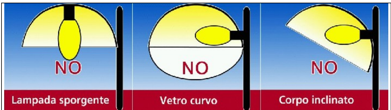
Figura 5.1 – Tipologie di apparecchi non ammessi
