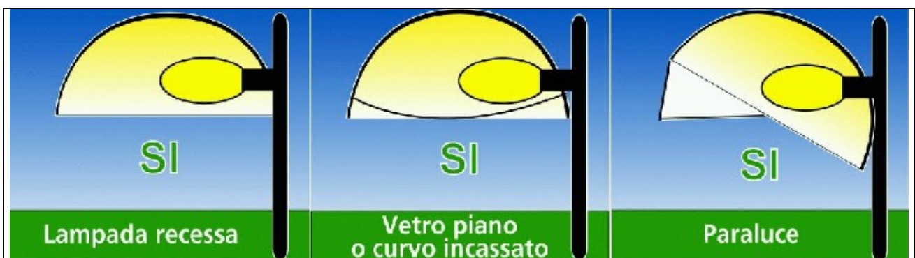
Figura 5.2 – Tipologie di apparecchi conformi alla legge n.17/2000
